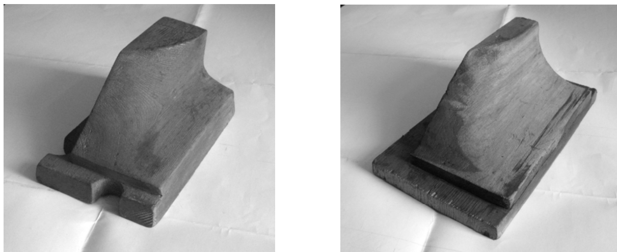
Рис. 4. Деревянные модели инструментов для обкатки конических и сферических днищ
